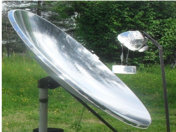
Şekil 1. Parabolik güneş fırını sisteminin genel görünüşü
